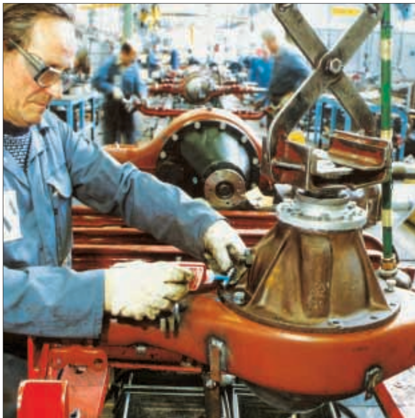
Одновременная фиксация и уплотнение винтов через отверстия дифференциала в осевой редуктор.
