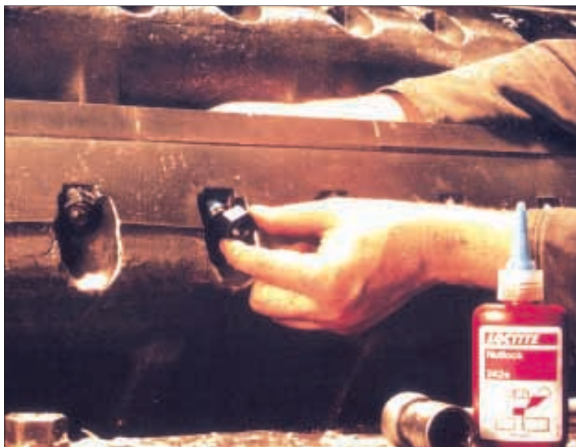
Винты ножей для резки пленки фиксировались самопорящейся гайкой и отвинчивались под действием вибрации. Теперь Локтайт 243 надежно фиксирует гайки.
