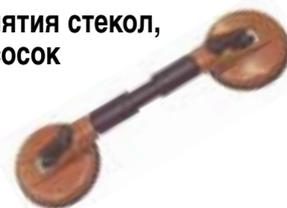
Приспособление, состоящее из двух присосок, было специально разработано для снятия и установки автомобильных стекол, имеющих любую кривизну поверхности. Резиновые присоски (диаметром 120 мм) можно заменять.
